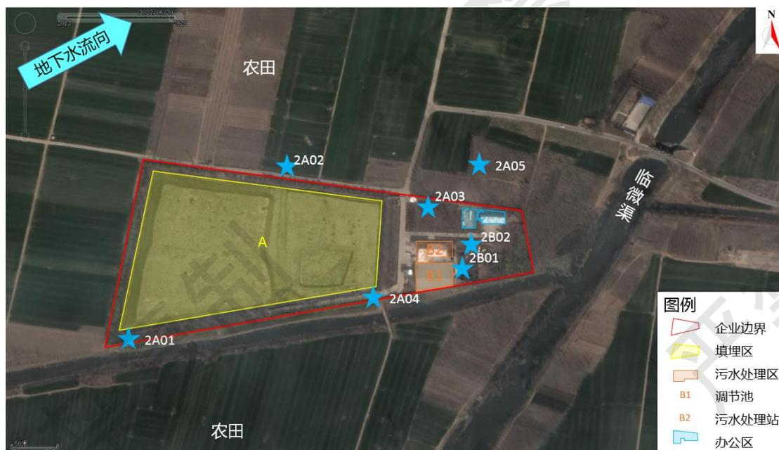
图 7-1 地下水监测井点位平面分布图
